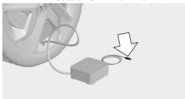
۴. فشار هوای تایر را روی 2 bar تنظیم کنید.
